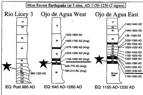
Secciones estratigráficas de tres lugares de excavaciones de trincheras en la parte central del Valle del Cibao, mostrando evidencias del gran terremoto que rompió la superficie del terreno a lo largo de la falla Septentrional hace 800 años. Los estratos debajo del que ha sido marcado con una estrella están deformados, mientras aquellos por encima no presentan deformación, porque fueron depositados después del terremoto.
